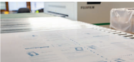
Die Druckplatten werden jeweils für eine der vier Druckfarben (Cyan, Magenta, Yellow und Schwarz) belichtet und mehrfach genutzt. Foto: GemeindebriefDruckerei
