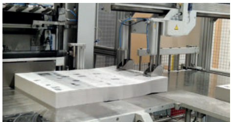
Die bedruckten Bögen werden automatisch sauber gestapelt und zum Schneiden weitertransportiert.
