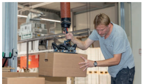
Die schweren Kartons werden mit Unterdruck gehoben Foto: GemeindebriefDruckerei
